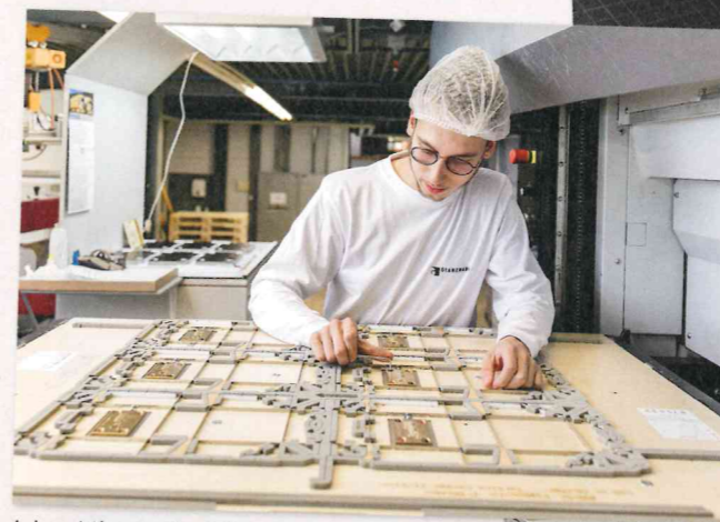
Ich schliesse die Klischees auf der Stanzform, um danach weitere Bereiche auf der Stanzmaschine einzurichten.
